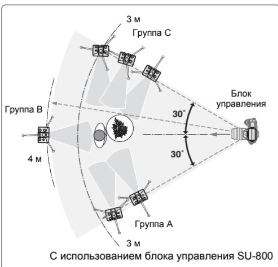
Рекомендуется считать, что эффективное расстояние между управляемым устройством и вспышкой SB-R200 составляет примерно 4 метра или меньше для фронтального положения и примерно 3 метра для боковых положений. Указанные расстояния могут незначительно меняться в зависимости от условий и/или окружающего освещения.
