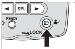
Если в пределах одной секунды нажать и отпустить кнопку “Пилотный свет” на блоке управления SU-800, то на вспышке SB-R200 примерно на одну секунду включается излучатель моделирующего света на пониженной мощности.
