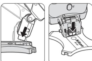
**3** Установите ножку крепления вспышки SB-R200 в установочный башмак подставки для вспышки AS-20 и сдвиньте блокиратор.
