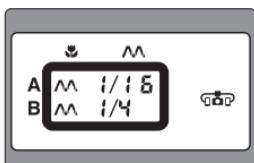
Для отображения мигающего значения мощности вспышки в ручном режиме нажмите кнопку [SEL](FUNC.). Для изменения значения нажмите кнопку [ $\blacktriangleleft$ ] или [ $\triangleright$ ].
