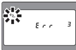
Устройство SU-800 невозможно использовать с камерами серии COOLPIX, за исключением COOLPIX P6000. В случае его использования индикатор беспроводного устройства вспышки мигает, предупреждая о некорректном использовании.
