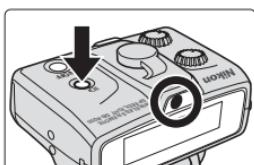
При нажатии на вспышке SB-R200 кнопки “Пилотный свет” и выключенном пилотном свете происходит его включение.
