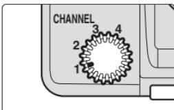
**9** Установка номера канала на вспышке SB-R200. Вращайте диск выбора канала [CHANNEL] на вспышке SB-R200 для установки номера канала. Убедитесь, что номер канала соответствует номеру на блоке управления SU-800.
