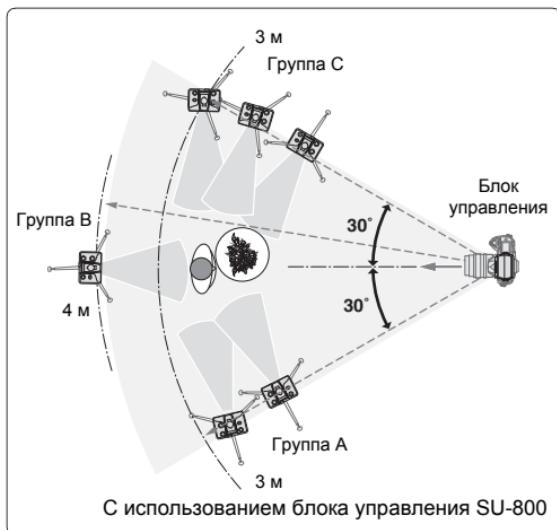
Варианты расположения вспышек SB-R200 зависят от используемой фотокамеры, оснащенной командным режимом, а также вспышки SB-900, SB-800. Дополнительные сведения см. в руководстве пользователя фотокамеры или вспышки.
