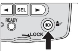
В пределах одной секунды нажмите и отпустите кнопку Target Light (Пилотный свет) на блоке управления SU-800. Вспышка SB-R200 многократно сработает на пониженной мощности. Это полезно для проверки распределения на объекте света и теней перед съемкой.
