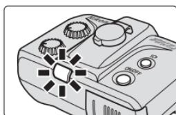
В режиме TTL, когда вспышка SB-R200 срабатывает на максимальной мощности и может иметь место недоэкспозиция, индикатор готовности на SB-R200 будет в течение примерно трех секунд мигать красным цветом. (Индикатор готовности на блоке управления SU-800 и в видоискателе фотокамеры не мигает.)
