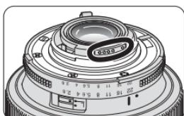
В данном руководстве объективы Nikkor разделены на две группы: объективы Nikkor с микропроцессором и без микропроцессора. Объективы с микропроцессором оснащены соответствующими контактами.
