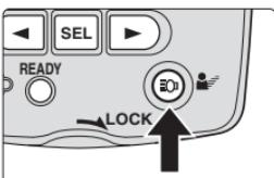
Нажмите и удерживайте более одной секунды кнопку "Пилотный свет" на блоке управления SU-800. Включится пилотный свет на вспышке SB-R200.
