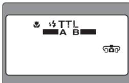
Индикация на экране в режиме вспышки TTL
