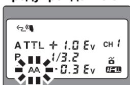
Если используется объектив без микропроцессора и установлен режим вспышки Вспышка с автоматической диафрагмой (AA), то будет мигать индикатор режима AA, предупреждая о том, что вспышки в группе не сработают.
