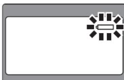
Индикатор разряда батареи мигает, если индикатор готовности блока управления SU-800 не загорается в течение примерно 30 секунд после включения питания или после срабатывания вспышки.
