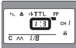
**5** Установка коэффициента выходной мощности вспышек SB-R200 между группами А и В (в режиме TTL).
