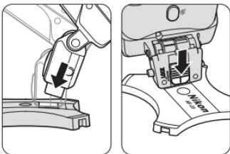
**2** Установите ножку крепления вспышки SB-R200 в установочный башмак подставки для вспышки AS-20 и сдвиньте блокиратор.
