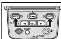
Нажмите одновременно кнопки [ON/OFF] и [MODE] (двухкнопочный сброс) для сброса всех установок, выбранных с помощью переключателя Commander/Macro (Командный/Макрорежим) к их значениям по умолчанию. Индикация на ЖК-экране мигнет 3 раза.
