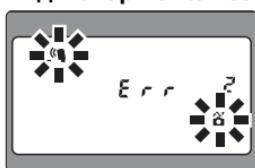
Если блок управления установлен на фотокамеру, несовместимую с CLS, то командный режим не работает. Отображение предупреждающих индикаторов, если установлен командный режим.
