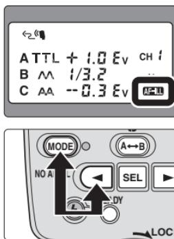
Вспомогательную подсветку АФ можно настроить на включение или отключение при получении управляющего сигнала от фотокамеры. Нажмите одновременно в течение примерно двух секунд кнопки [MODE] + [◀] для переключения между параметрами AF-ILL (включено) и NO AF-ILL (отключено).
