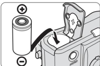
**2** Установите батарею и закройте крышку батарейного отсека, сдвинув ее на прежнее место. Используйте литиевые батареи CR123A (3 В).
