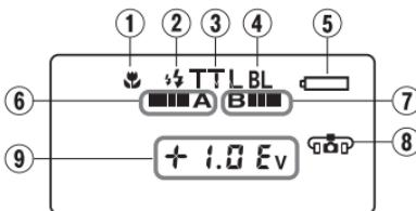
Индикация на экране в режиме TTL BL
