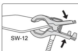
4 Используйте гибкий кронштейн с зажимами SW-C1 для закрепления рассеивателя SW-12.
