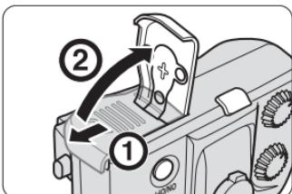
**1** Откройте крышку батарейного отсека, сдвинув ее в направлении, указанном стрелкой.
