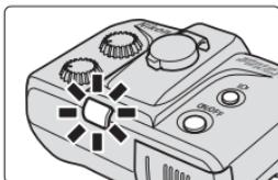
В режиме TTL, когда вспышка SB-R200 срабатывает на максимальной мощности и может иметь место недоэкспозиция, индикатор готовности на SB-R200 будет в течение примерно трех секунд мигать красным цветом. (Индикатор готовности на блоке управления SU-800 и в видеоискателе фотокамеры не мигает.)
