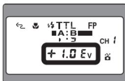
**6** Установка значения поправки мощности вспышки SB-R200 (в режиме TTL).
