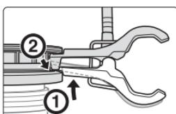
3 Удерживая одну из рукояток, отпустите вторую, чтобы фиксатор попал в паз на кольце, затем отпустите обе рукоятки.
