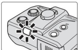
В режиме TTL, когда вспышка срабатывает на максимальной мощности и может иметь место недоэкспозиция, индикатор готовности на данной вспышке будет в течение примерно трех секунд мигать красным цветом. (Индикатор готовности на блоке управления SU-800 и в видоискателе фотокамеры не мигает.)
