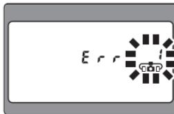
Если при использовании фотокамер, несовместимых с CLS, блок управления SU-800 и вспышка SB-R200 соединены с помощью кабеля неправильно, мигает индикатор Using cords (Использование кабеля).
