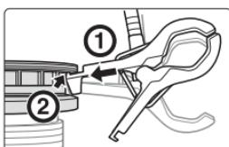
2 Вставьте установочный паз кронштейна SW-C1 в паз на передней части присоединительного кольца SX-1, как показано на рисунке.
