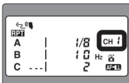
Для отображения мигающего номера канала нажмите кнопку [SEL](FUNC.) на блоке управления SU-800. Чтобы изменить номер канала, нажмите кнопку [ $\blacktriangleleft$ ] или [ $\triangleright$ ]. Нажмите еще раз кнопку [SEL](FUNC.) — номер канала перестанет мигать. Последнее мигающее значение — это значение, которое установлено автоматически.
