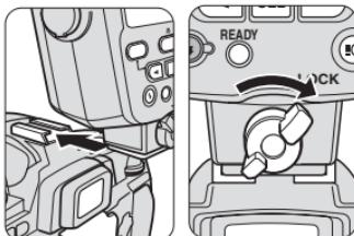
**4 Поверните влево фиксатор ножки крепления, вставьте ножку крепления блока управления SU-800 в башмак для принадлежностей фотокамеры и поверните фиксатор вправо.**
