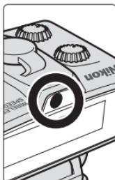
Нажмите и удерживайте кнопку “Пилотный свет” на блоке управления SU-800 более одной секунды. Загорятся все источники пилотного света на вспышках SB-R200.
