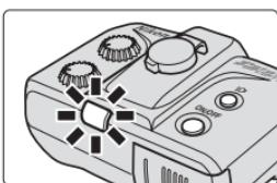
В режиме TTL, когда вспышка SB-R200 срабатывает на максимальной мощности и может иметь место недодозировка, индикатор готовности на SB-R200 будет в течение примерно трех секунд мигать красным цветом. (Индикаторы готовности на блоке управления SU-800 и в видоискателе фотокамеры не мигают).
