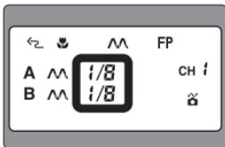
Для отображения мигающего значения мощности вспышки в ручном режиме нажмите кнопку [SEL](FUNC.). Для изменения значения нажмите кнопку [ $\blacktriangleleft$ ] или [ $\triangleright$ ]. Нажмите еще раз кнопку [SEL](FUNC.) — значение коэффициента мощности вспышек перестанет мигать. Последнее мигающее значение — это значение, которое установлено автоматически.
