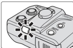
В режиме TTL, когда вспышка SB-R200 срабатывает на максимальной мощности и может иметь место недоэкспозиция, индикатор готовности на SB-R200 будет в течение примерно трех секунд мигать красным цветом. (Индикаторы готовности на блоке управления SU-800 и в видоискателе фотокамеры не мигают).
