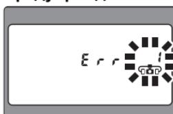
Если при использовании CLS-совместимых фотокамер блок управления SU-800 и вспышка SB-R200 соединены с помощью кабеля, то отображается индикатор Err и мигает индикатор Using cords (Использование кабеля).
