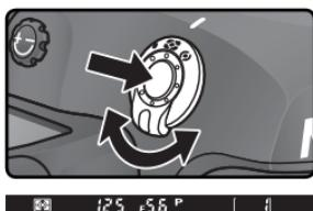
Если включен матричный замер, то дисплей видоискателя показывает тип замера символом ☰.
