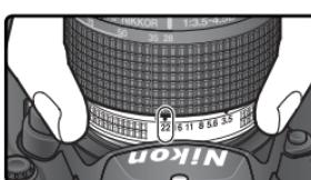
Если Вы не сделаете этого при установке объектива со встроенным процессором, то при включении фотокамеры на контрольном дисплее и в видоискателе будет мигать значение диафрагмы  $f\#E$ . Фотографии нельзя будет сделать до тех пор, пока Вы не выключите фотокамеру и не заблокируете диафрагму объектива на максимальном f/числе.
