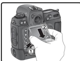
Чтобы установить крышку монитора перед съемкой или перед тем, как убрать фотокамеру на хранение, вставьте эти два выступа сверху крышки в соответствующие углубления на корпусе фотокамеры выше монитора (①), затем аккуратно нажмите на нижнюю часть крышки, пока не услышите, как она со щелчком встанет на свое место (②).
