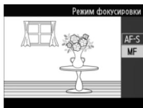
Если объектив поддерживает автофокусировку с ручной донастройкой, то после фокусировки с помощью автофокусировки можно продолжать удерживать спусковую кнопку затвора нажатой наполовину и поворачивать кольцо фокусировки объектива, чтобы выполнить тонкую настройку фокусировки вручную. Для повторной фокусировки с помощью автофокусировки снова нажмите спусковую кнопку затвора наполовину.
